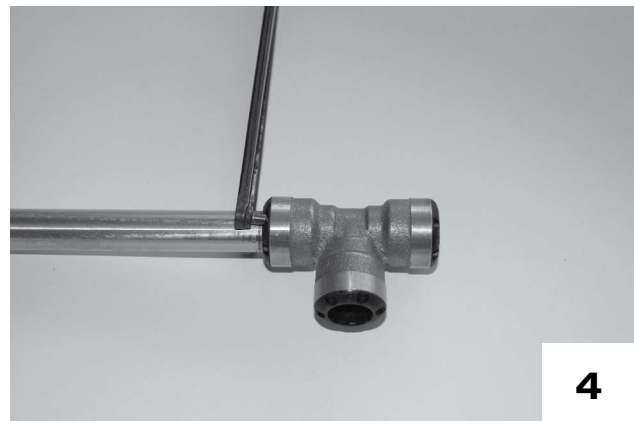
Kunststoffhülse bis zum Anschlag anziehen.
