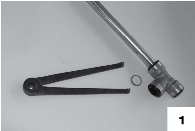
Benötigtes Material, Werkzeug: Roter Kunststoffring Art 9896, Schlüssel 9895.
